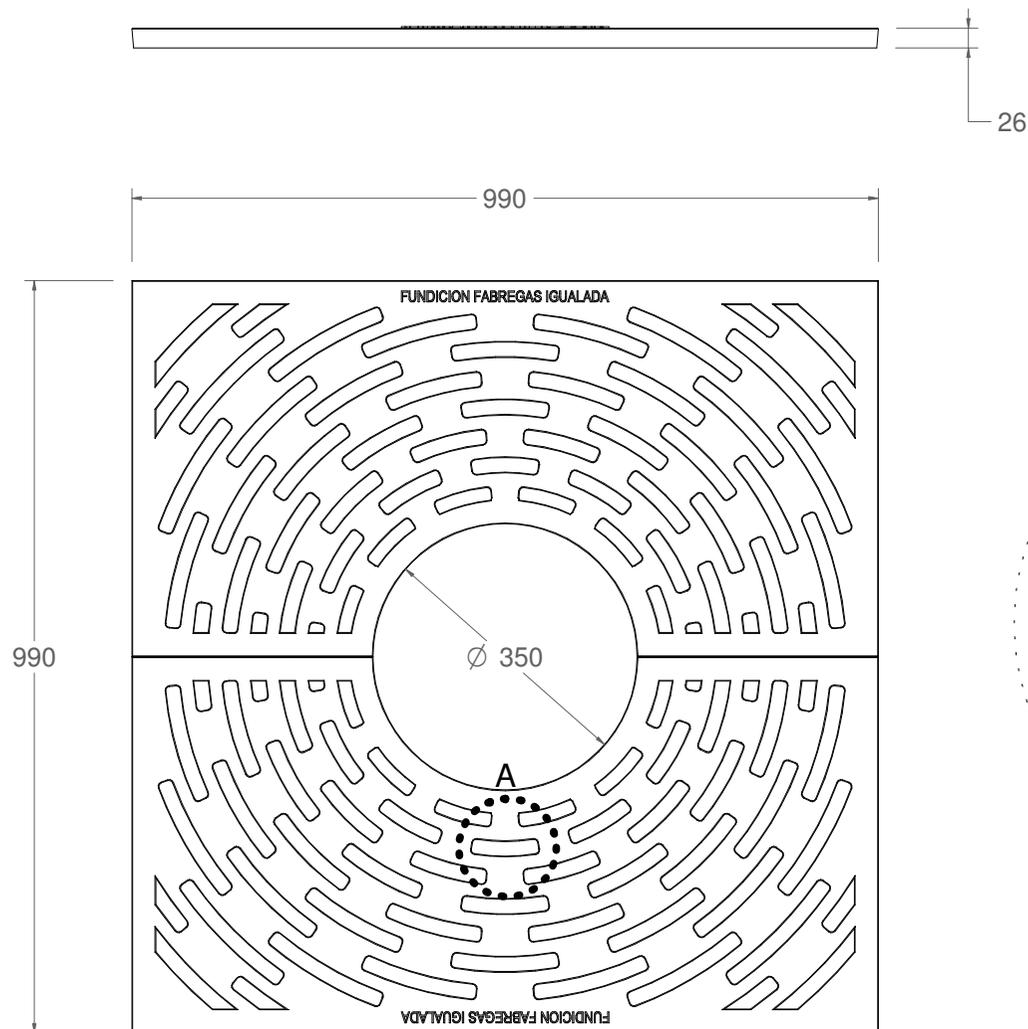
Material: Fundición ductil GGG40
